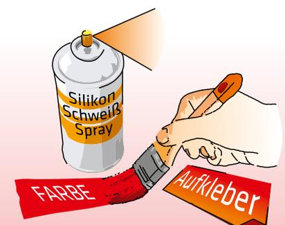
Diese Anhaftungen führen zu Fehlstellen. Sie können bei der Vorbehandlung NICHT entfernt werden.
