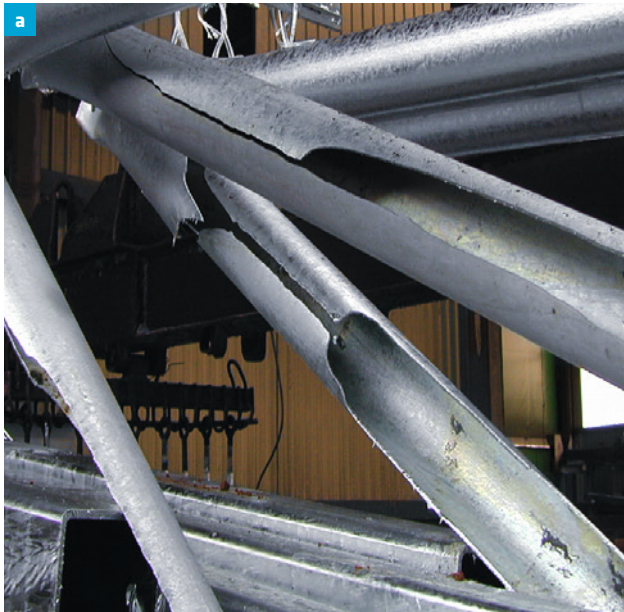
a Gerissene Rohrprofile aus Feinkornbaustahl
