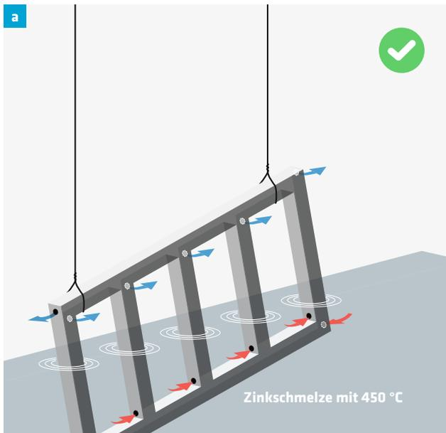
**a** Werkstück mit korrekten Bohrungen: Zu- und Ablauf sind OK.
