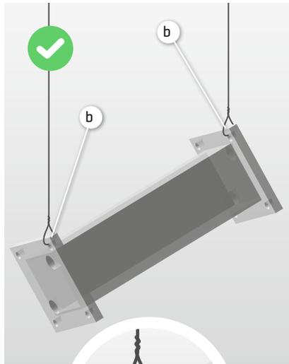
**c** Sichere Aufhängung über speziell angeschweisste Aufhängeösen
