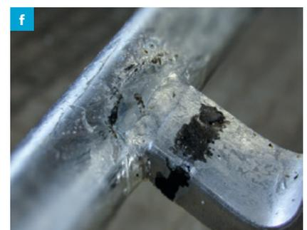
**g h** Auch der Schweißprozess hinterlässt Rückstände wie Schlacken oder Schweißspritzer. Auf den glasigen Schweißschlacken kann sich keine Legierung ausbilden. Verbleibende Schweißspritzer werden zwar mitverzinkt, beeinträchtigen aber die Oberflächenglätte (Pickel).
