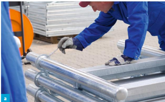
a Eine gegebenenfalls notwendige Ausbesserung einer beschädigten Feuerverzinkung muß mit besonderer Sorgfalt ausgeführt werden.
